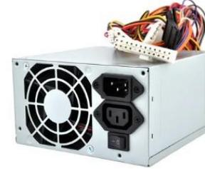
Le BLOC d'alimentation : C'est lui qui fournit à l'ordinateur fixe et aux composants, l'électricité nécessaire pour fonctionner.
